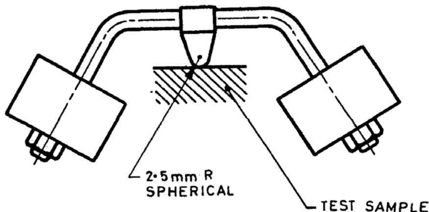
FIG. 13 BALL PRESSURE TEST
