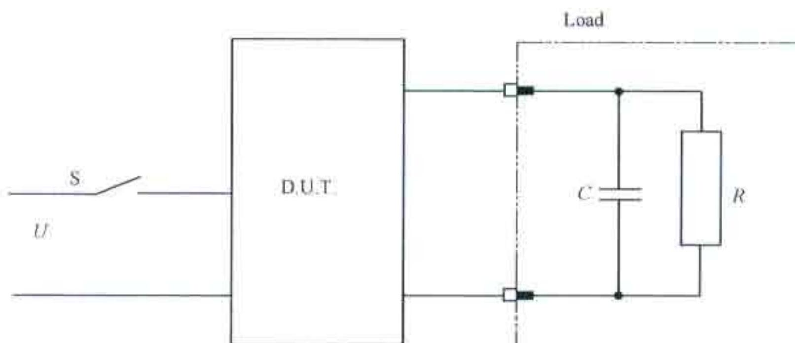
a) 启动过程中的电流测量线路
